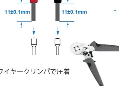
剥がしたケーブルをワイヤークリンパで圧着
