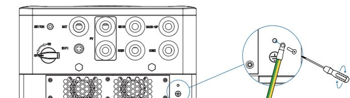
注記: インバータのアース接続ケーブル（ポイント）がPVフレームのアースケーブルから分離されていることを確認してください。
