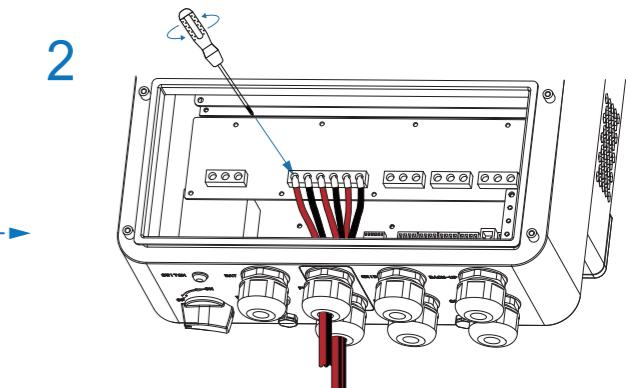
皮をむいた電線を防水コネクタに挿入し、インバータの端子指示に従ってDC入力線を極性を正しく接続し、ボルトを締め付けてください。
