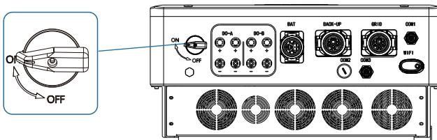
DC スイッチとAC 回路ブレーカーをオンにし、監視モジュールのLED インジケーターが点滅して、監視モジュールが正常に接続されたことを示すまで待ちます。
