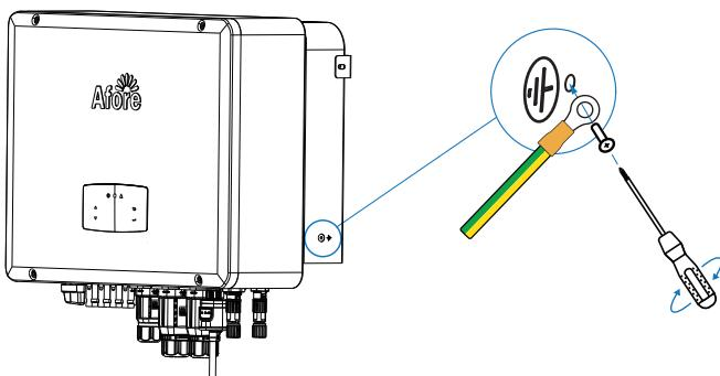
接地ネジを機械ハウジングの接地接続に固定します。
