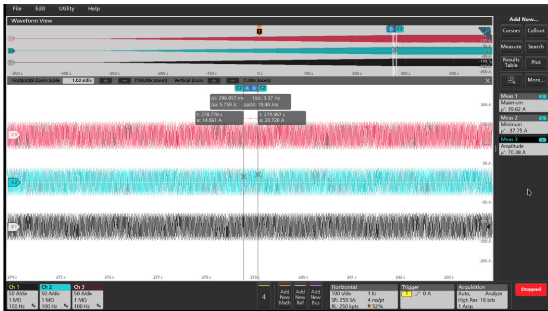
図4.8_10 ソフトスタート機能試験波形_V相拡大波形 (60Hz)
