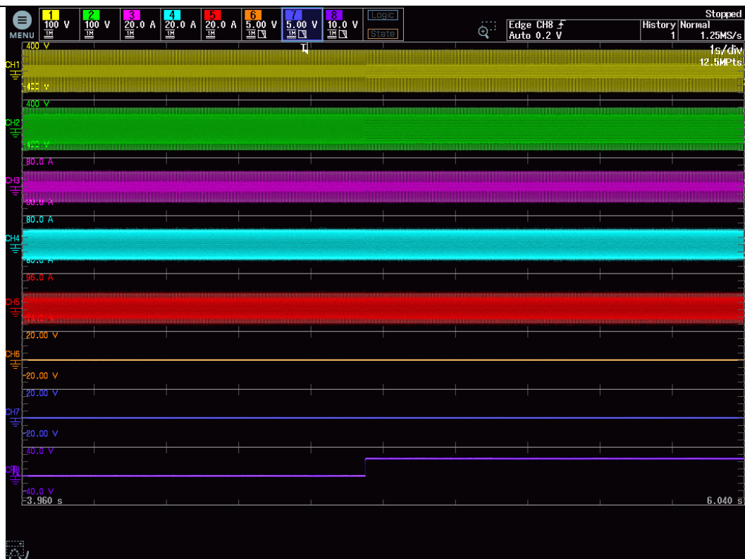
図3. 2. 11. 1_2総合高調波電圧成分を1. 8V急増試験波形 (50Hz)
