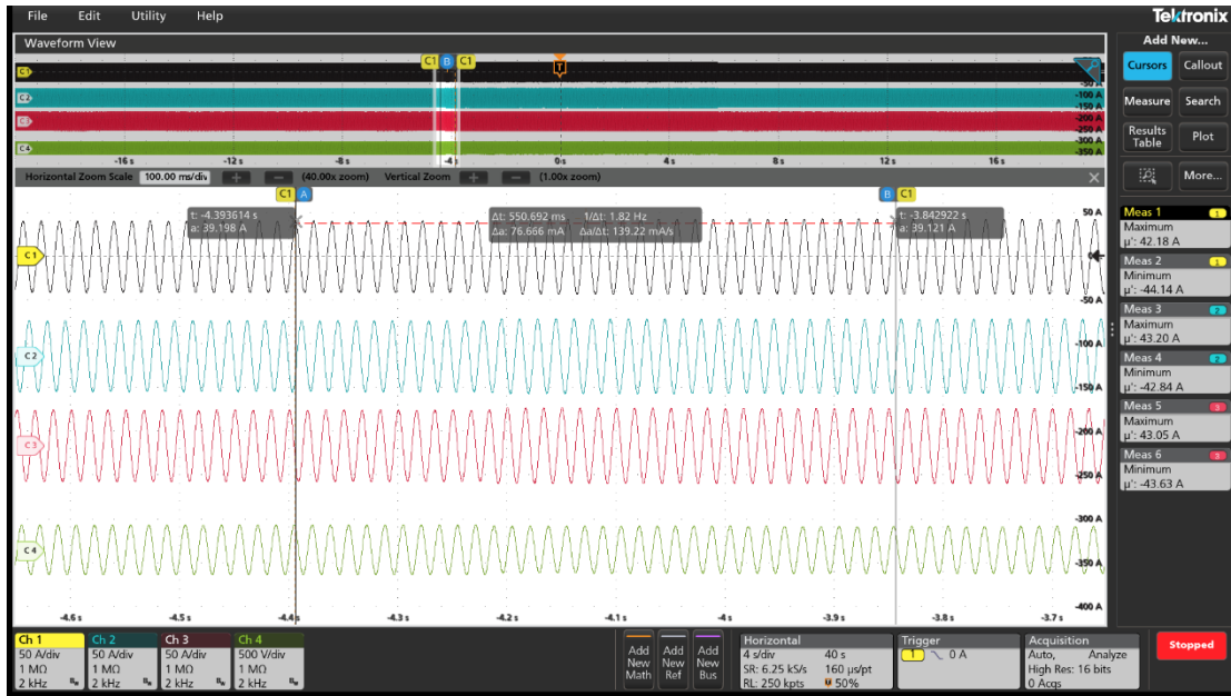
図5.2_11 100%-95% 拡大波形 (60Hz)
