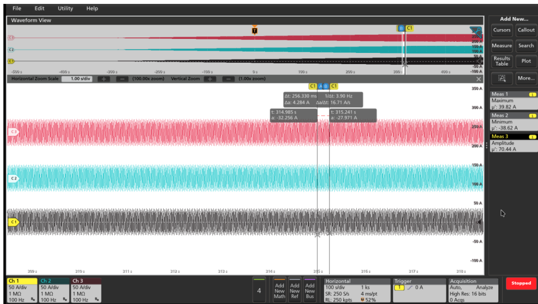
図4.8_2 ソフトスタート機能試験波形_ U相拡大波形 (50Hz)
