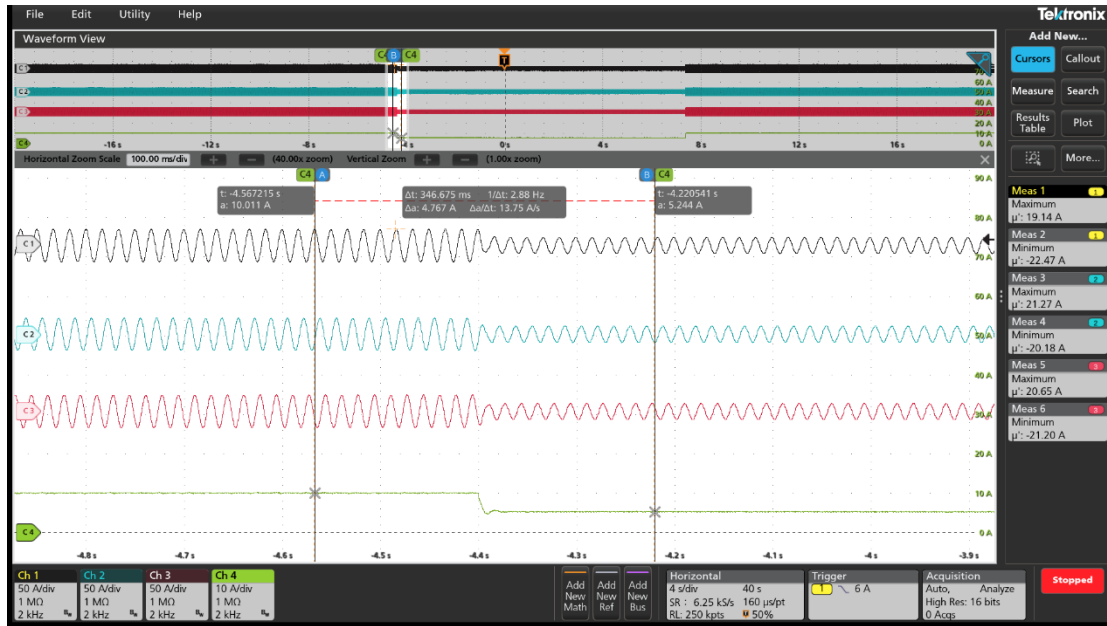
图5.1.1_11 50%-25% 拡大波形 (60Hz)
