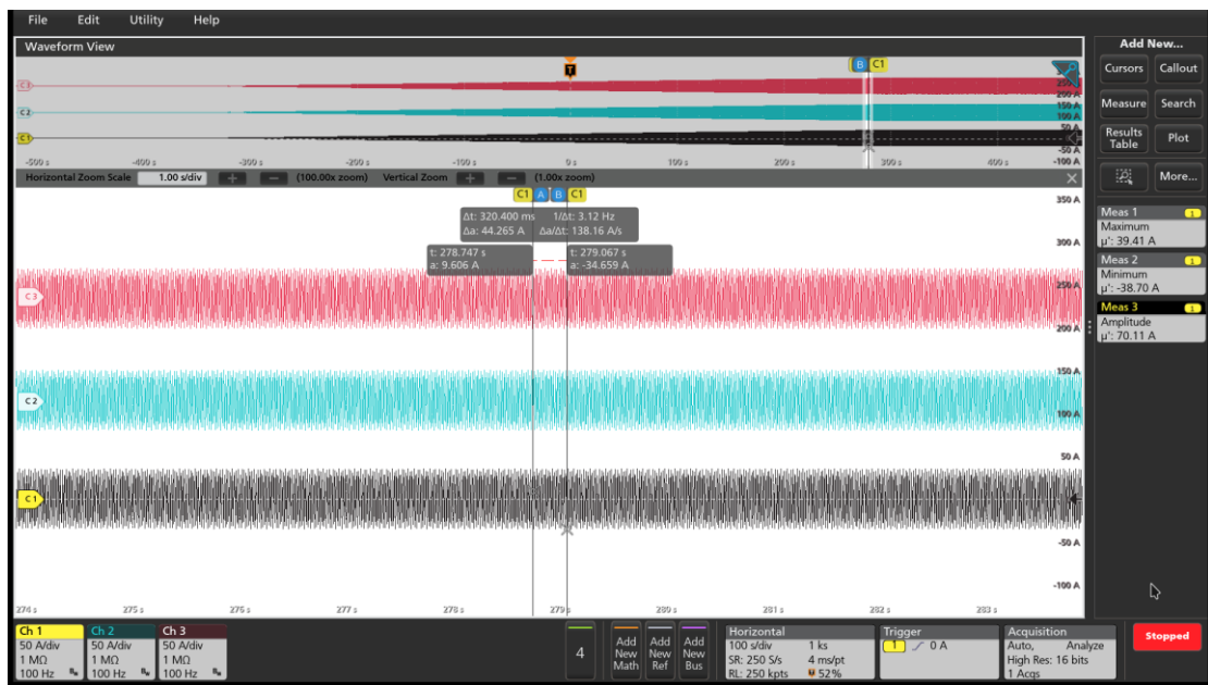
図4.8_8 ソフトスタート機能試験波形_ U相拡大波形 (60Hz)
