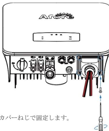
AC 配線カバーをカバーねじで固定します。
