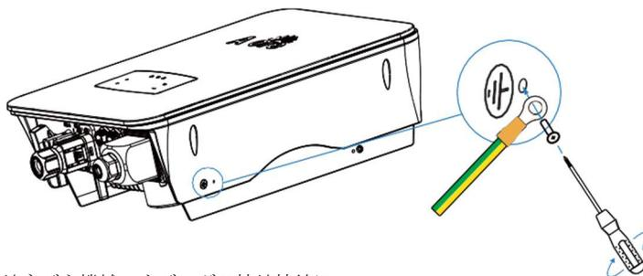
接地ネジを機械ハウジングの接地接続に固定します。
