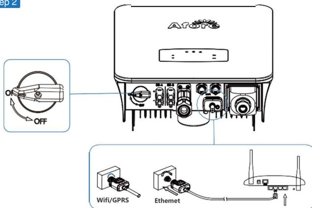
DC スイッチと AC 回路ブレーカーをオンにし、監視モジュールの LED インジケーターが点滅して、監視モジュールが正常に接続されたことを示すまで待ちます。
