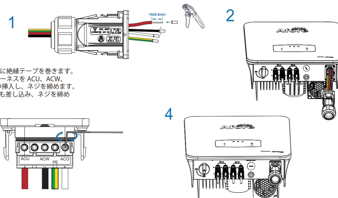
1. 端子を圧着後、接続箇所に絶縁テープを巻きます。
