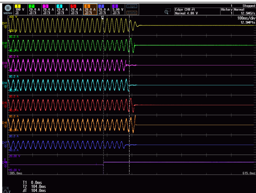
図3.2.8.1_45 試験回数 9 _ 測定回数 15 _ PCS 7 解列時間試験波形 (50Hz)
