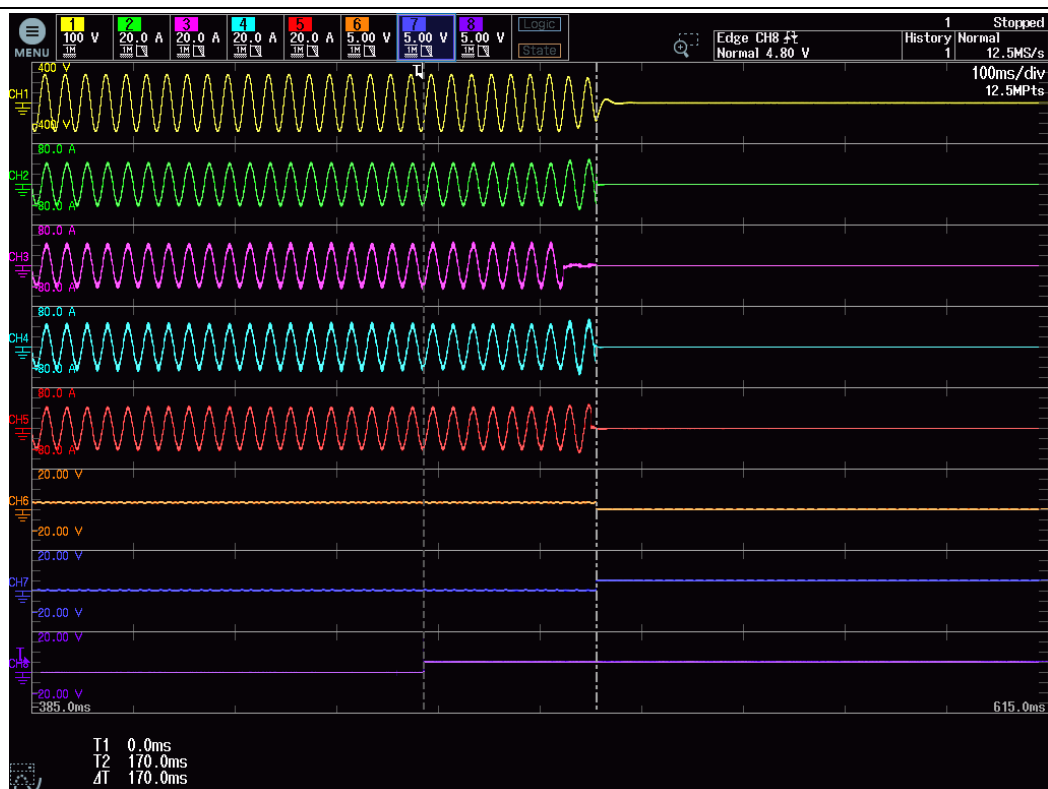
図3.2.8.2_21 測定回数 15_PCS 1 解列時間試験波形 (50Hz)
