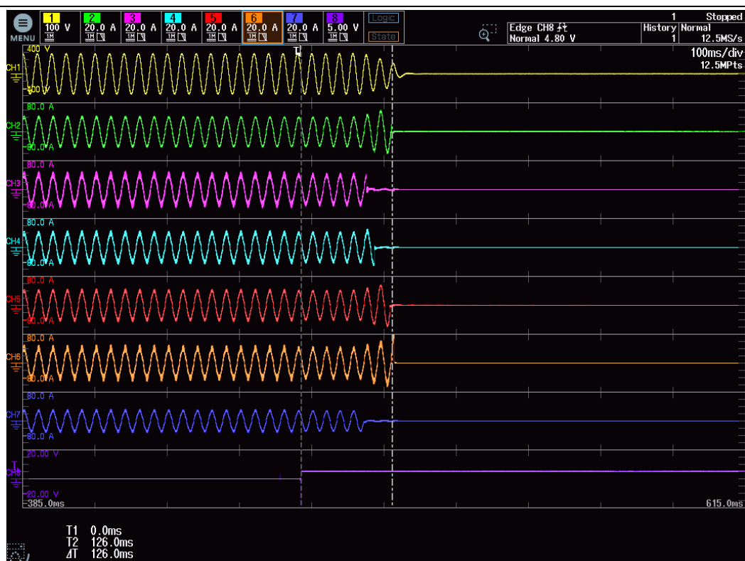
図3.2.8.1_43 試験回数 9 _ 測定回数 15 _ PCS 5 解列時間試験波形 (50Hz)
