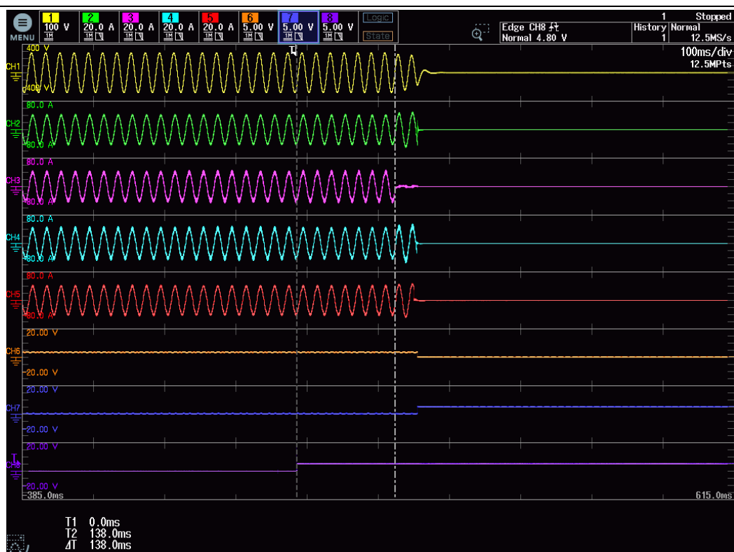
図3.2.8.2_22 測定回数 15_PCS 2 解列時間試験波形 (50Hz)
