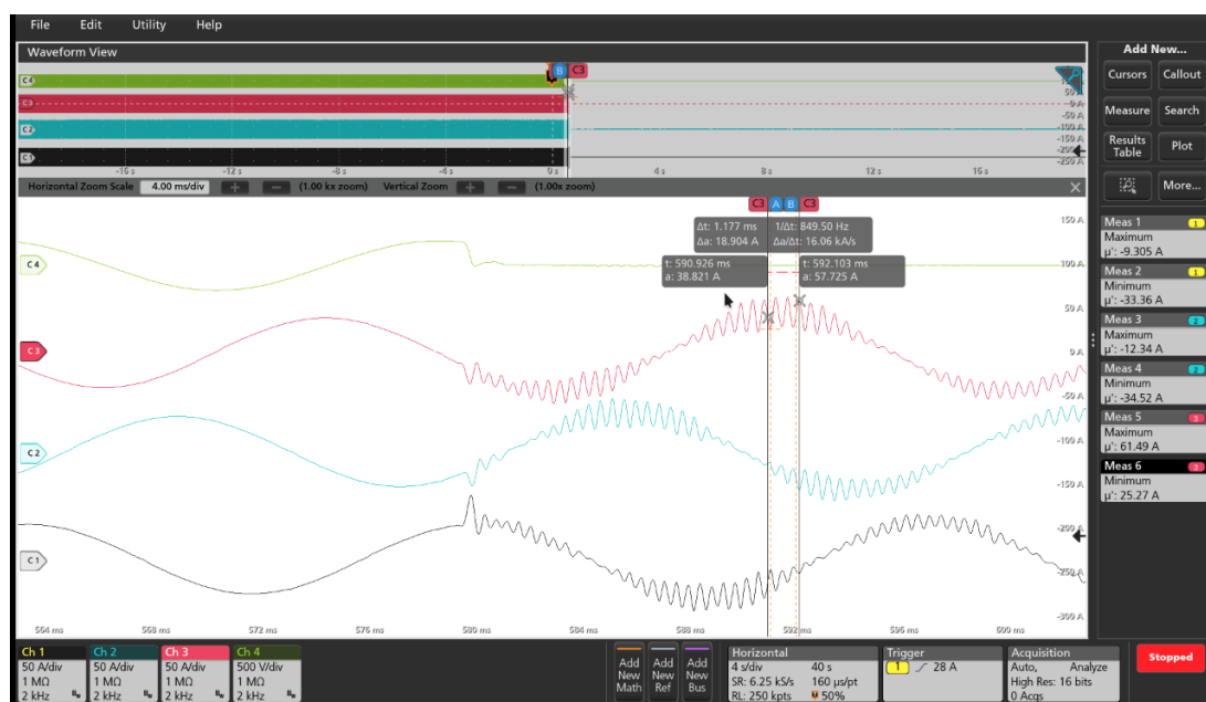
図6.1_6 W相交流短絡電流150%超過保護時間(60Hz)
