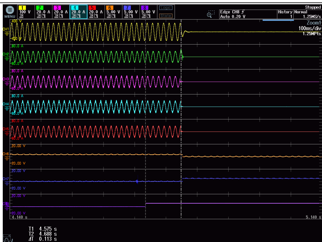
図3.2.8.1_79 試験回数 9 _ 測定回数 6 _ PCS 3 解列時間試験波形 (60Hz)
