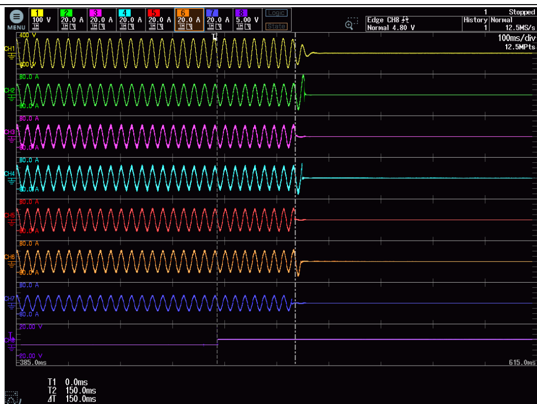
図3.2.8.2_28 測定回数 15_PCS 8 解列時間試験波形 (50Hz)
