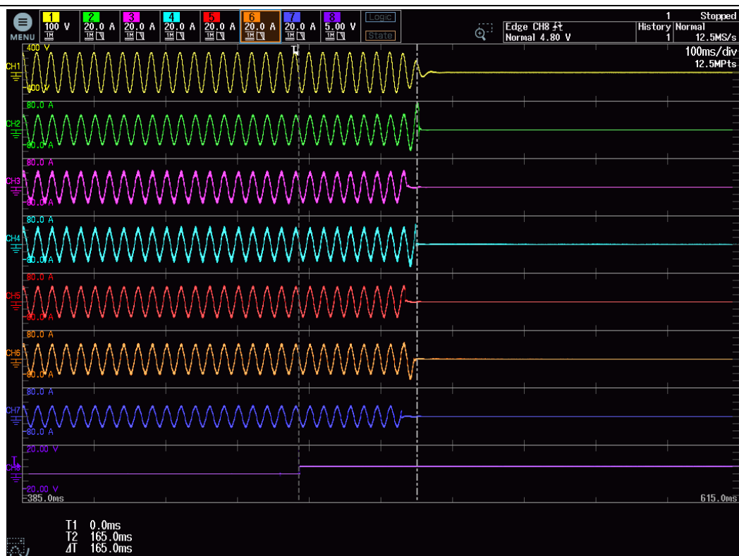
図3.2.8.2_27 測定回数 15_PCS 7 解列時間試験波形 (50Hz)
