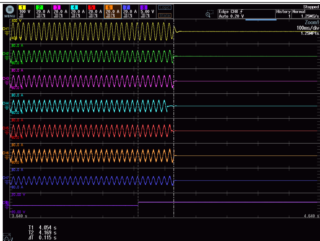
図3.2.8.1_92 試験回数 9 _ 測定回数 12 _ PCS 6 解列時間試験波形 (60Hz)
