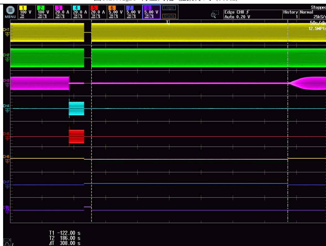
図3.2.7.1_23 再並列化 能動方式 (60Hz)
