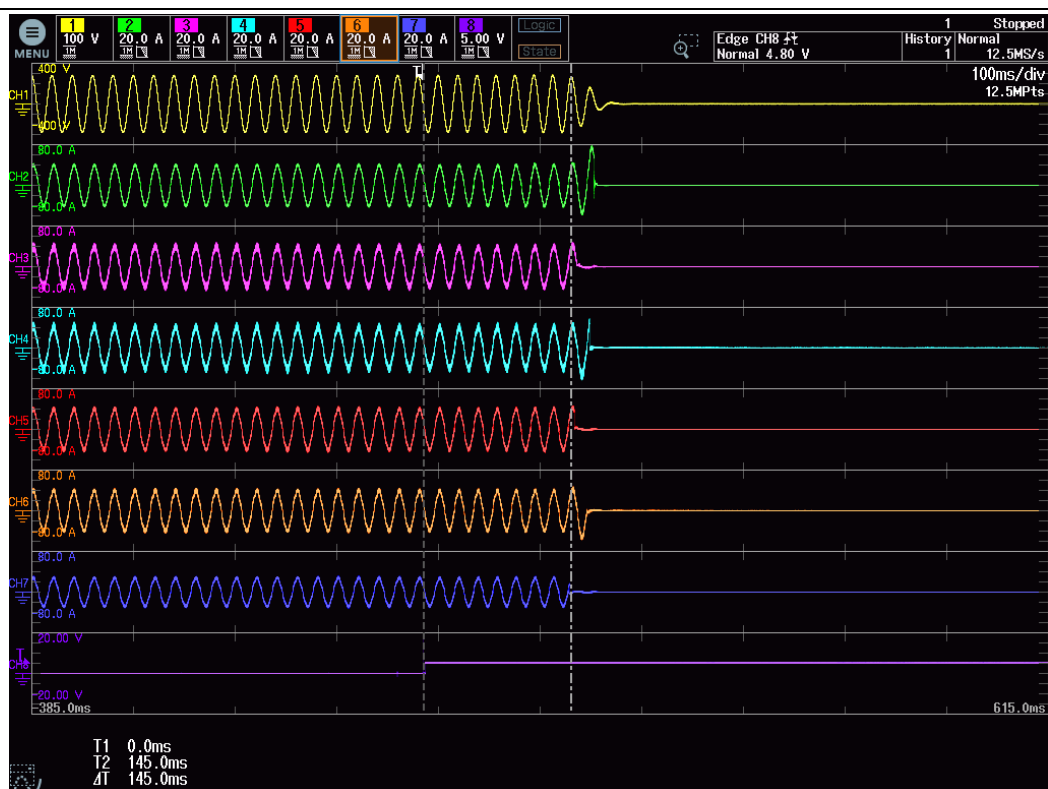
図3.2.8.2_30 測定回数 15_PCS 10 解列時間試験波形 (50Hz)
