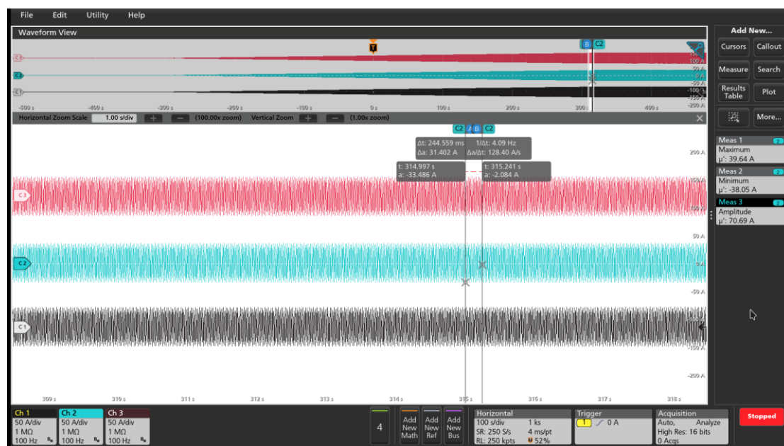
図4.8_4 ソフトスタート機能試験波形_V相拡大波形(50Hz)
