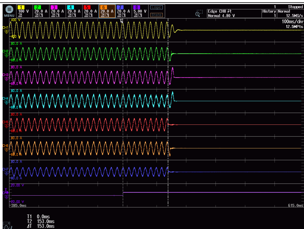
図3.2.8.2_18 測定回数 9 _ PCS 8 解列時間試験波形 (50Hz)
