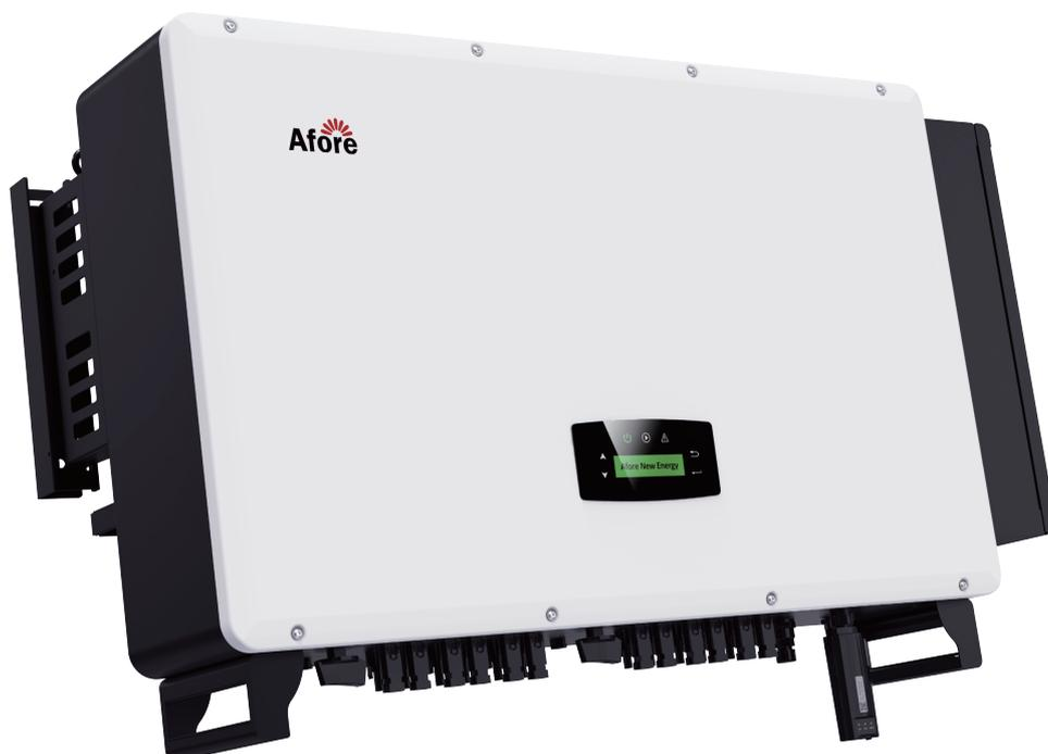
Afore BNT三相ストリング型パワーコンディショナは、商業用、産業用、太陽光発電所システム用に設計されており、定格出力は70kWから110kWです。すべての型番は、耐久性と酸やアルカリによる腐食から保護するための陽極酸化処理仕上げを施したアルミニウム製の一体型ハウジングを特徴としています。熱放散を保証する外部インダクタを装備し、製品の信頼性と寿命を大幅に向上させます。
