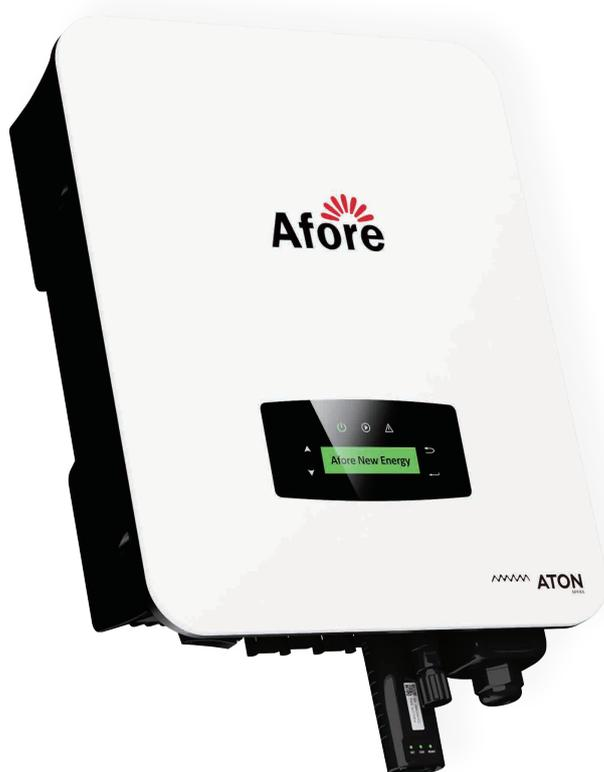
AforeのBNT9.9KTLは家庭用、小規模商業用向けに開発されたPV用3相ストリングインバータです。全てのモデルはアルミダイキャスト構造となっており、耐久性、耐腐食性、を実現しています。
