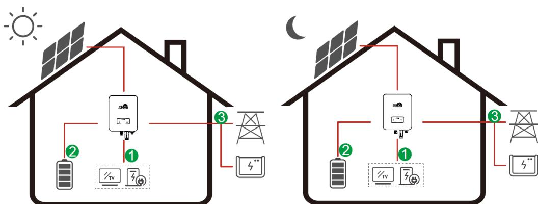
電力の流れ: PV → 電化製品／スマート電器 → 蓄電池 → 送電網(発電機)
