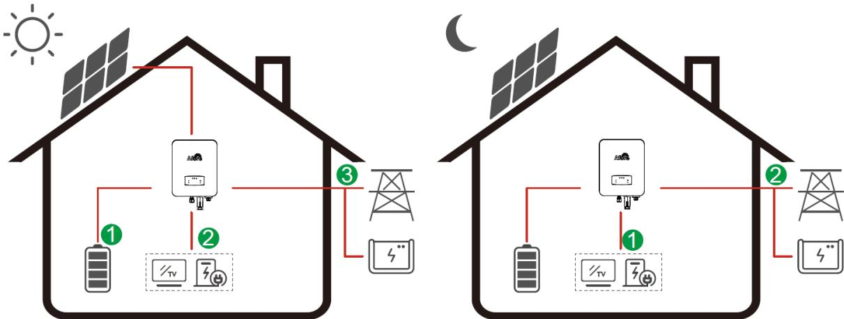
電力の流れ: PV → 蓄電池 → 電化製品／スマート電器 → 送電網(発電機)
