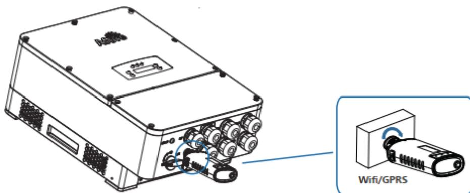
DC スイッチと AC 回路ブレーカーをオンにし、監視モジュールの LED インジケーターが点滅するまでお待ちください。点滅が確認できれば、モニタリングモジュールが正常に接続されていることを示します。
