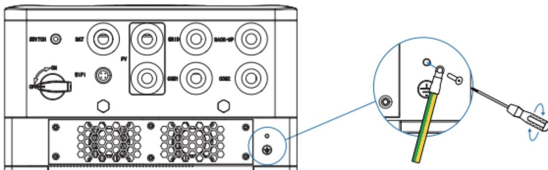
接地ネジを、パワーコンディショナー筐体の接地接続部に確実に固定してください。
