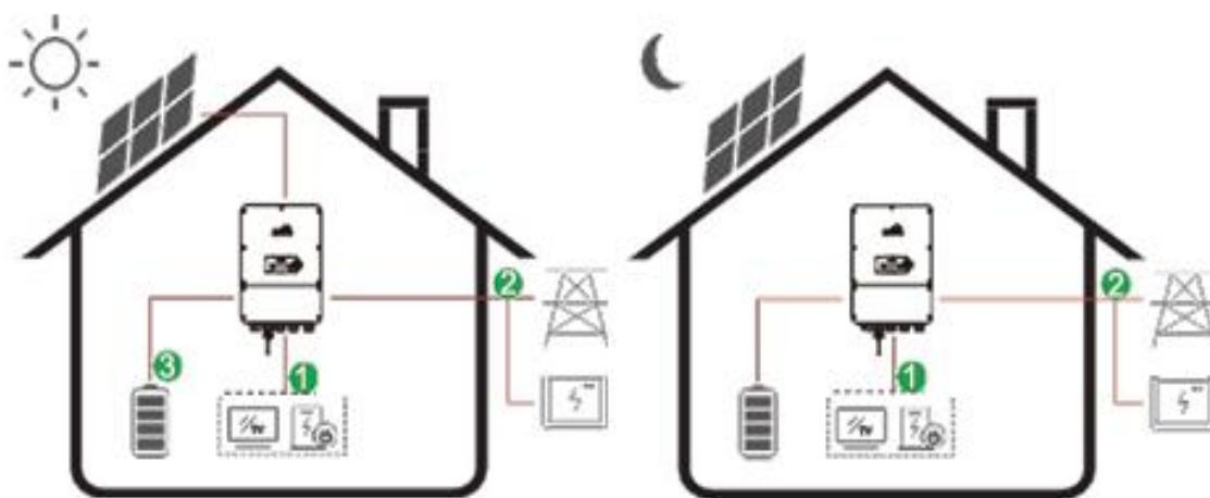
電力の流れ: PV → 電化製品／スマート電器 → 送電網(発電機) → 蓄電池
