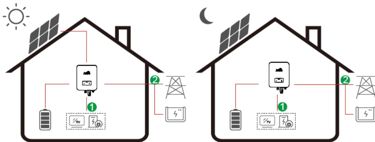
電力の流れ: 蓄電池と PV → 電化製品／スマート電器 → 送電網(発電機)
