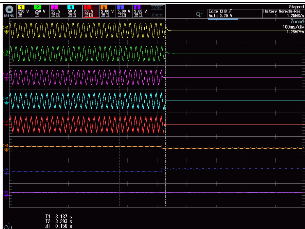
図2.6.1_14 並列接続の数 3 _ 測定回数 15 _ PCS 2 解列時間試験波形 (50Hz)
