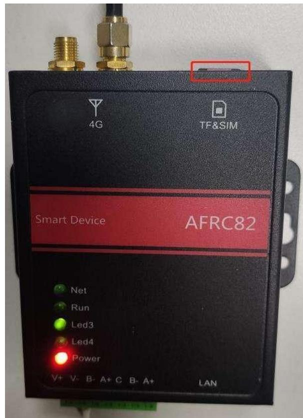
6. NetランプとRunランプが、TFカードを抜く前に 3 回点滅することを確認します。
