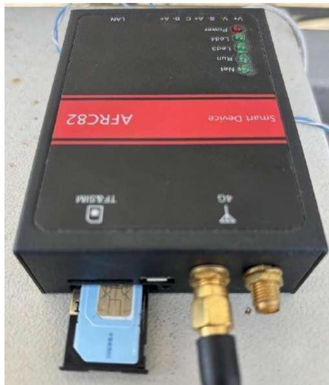
図のように、SIM カードをスロットに挿入し、4G アンテナを接続する必要があります。
