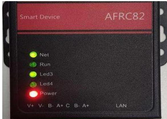
出力制御ユニットに電源を入れると、赤色の電源ランプが常時点灯し、緑色のRunランプが点滅します。
