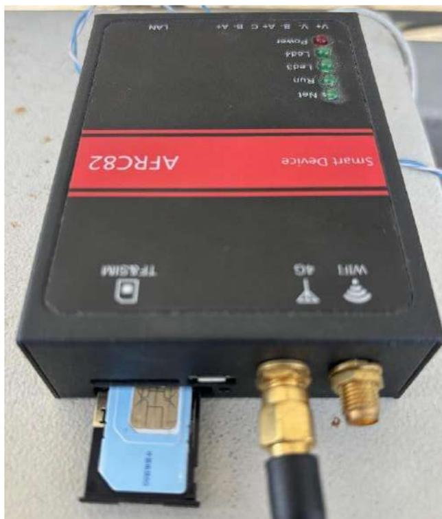
図のように、SIM カードをスロットに挿入し、同時に 3G/4G アンテナを接続する必要があります。
