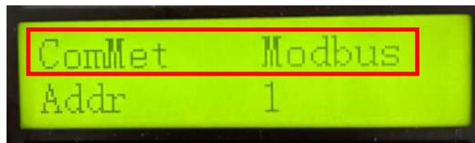
↓を押して modbus を選択し、選択が完了した後、次のステップに進むことができます、同じように、アドレスと伝送速度を設定することができます、伝送速度の選択 115200、次のチャート：
