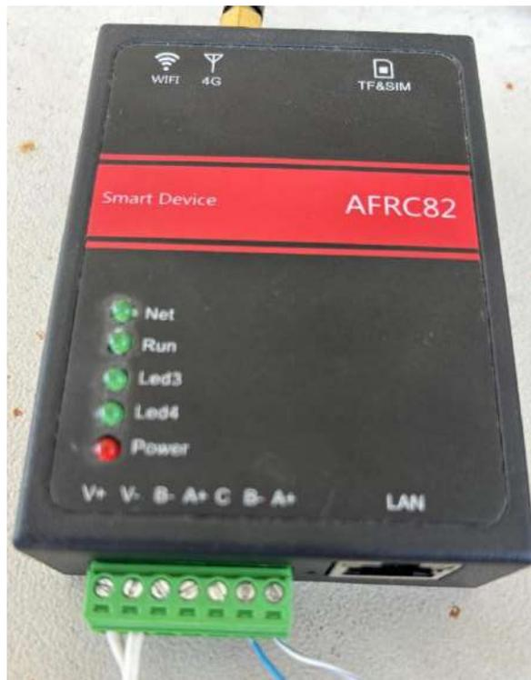
出力制御ユニットの配線は図の通り、一番右の 6P ポートが 5V 電源に接続 一番右の A B 端子がインバーターに接続 配線については 3.2.3 を参照。
