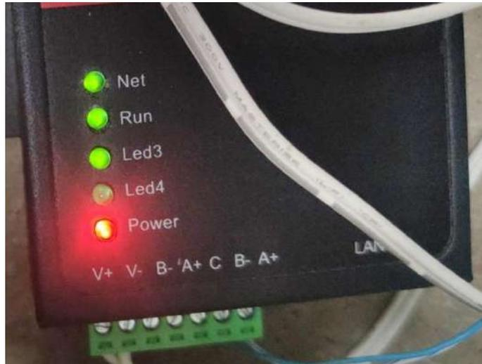
出力制御ユニットに電源が投入されると、赤色の電源ランプが常時点灯し、緑色のシステムランプが点滅し、緑色のネットワークランプが一度点灯した後、システムが正常にダイヤルアップするまで消灯し、その後ネットワークランプが常時点灯します。
