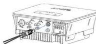
4. 通信ケーブルのもう一方の端もストリップされ、赤が端子 A に、黒が端子 B に接続される。
