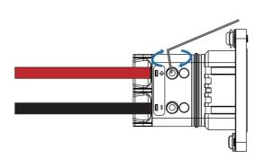
4 バッテリーコネクタをインバーターに差し込み、「カチッ」と音がしたら、これはバッテリーの接続が完了したことを意味します。
