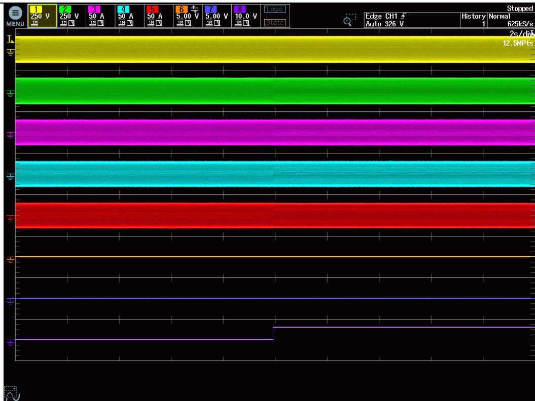
CH1: UV 電圧; CH2: VW 電圧; CH3: U 相電流; CH4: V 相電流; CH5: W 相電流; CH6: 能動機能状態信号; CH7: リレー信号; CH8: 模擬電力系統トリガ信号
