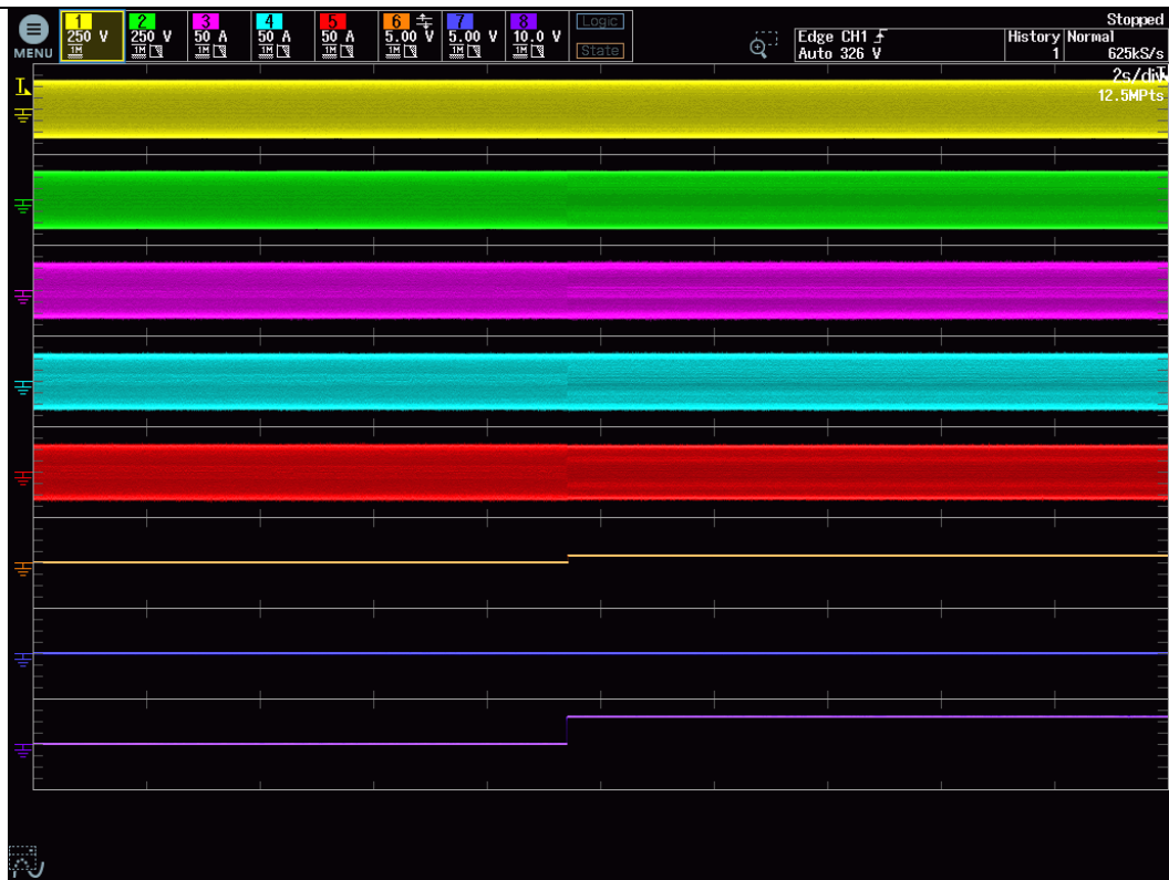
図3. 2. 11. 1_1総合高調波電圧成分を2. 2V急増試験波形 (50Hz)
