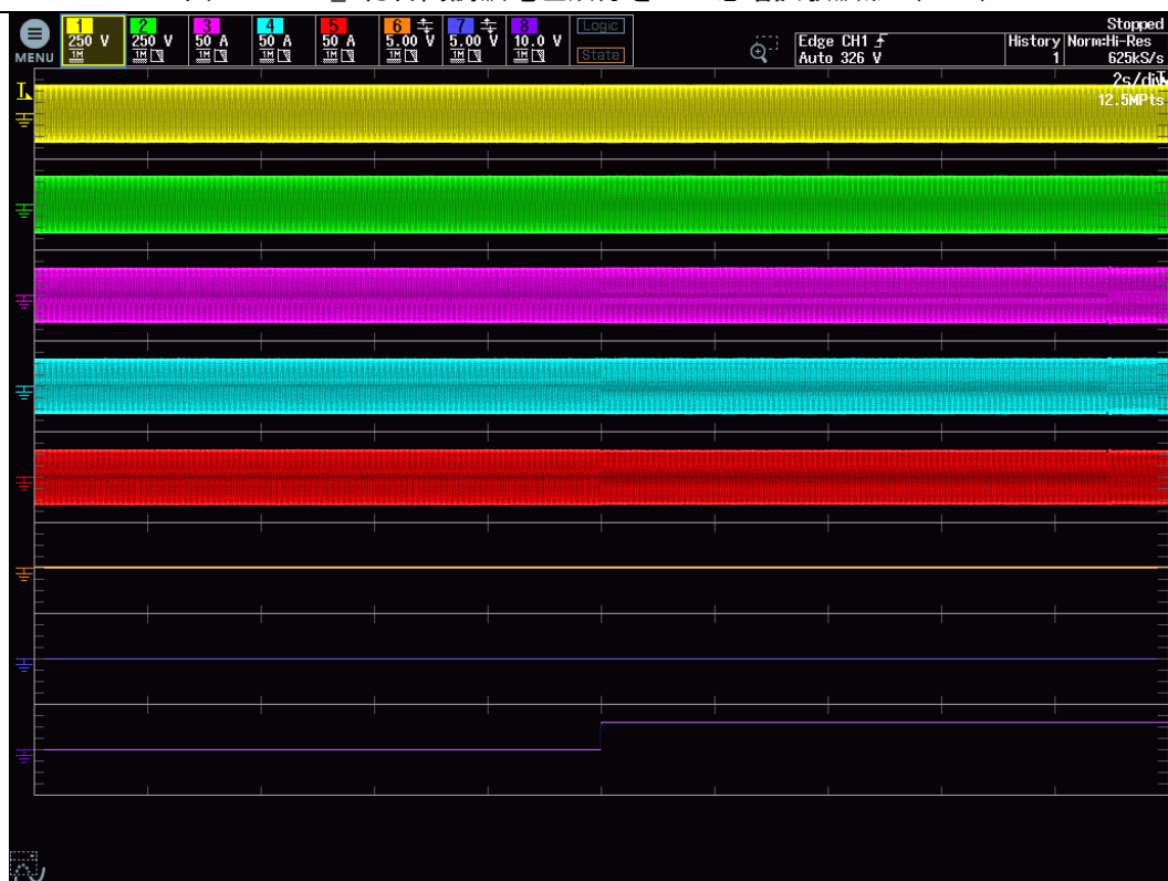
図3. 2. 11. 1_4総合高調波電圧成分を1.8V急増試験波形 (60Hz)
